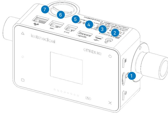
Abbildung 7: Elektrische Schnittstellen
