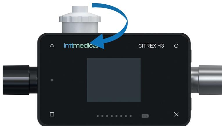
Abbildung 5: Sauerstoff-Sensor einschrauben
