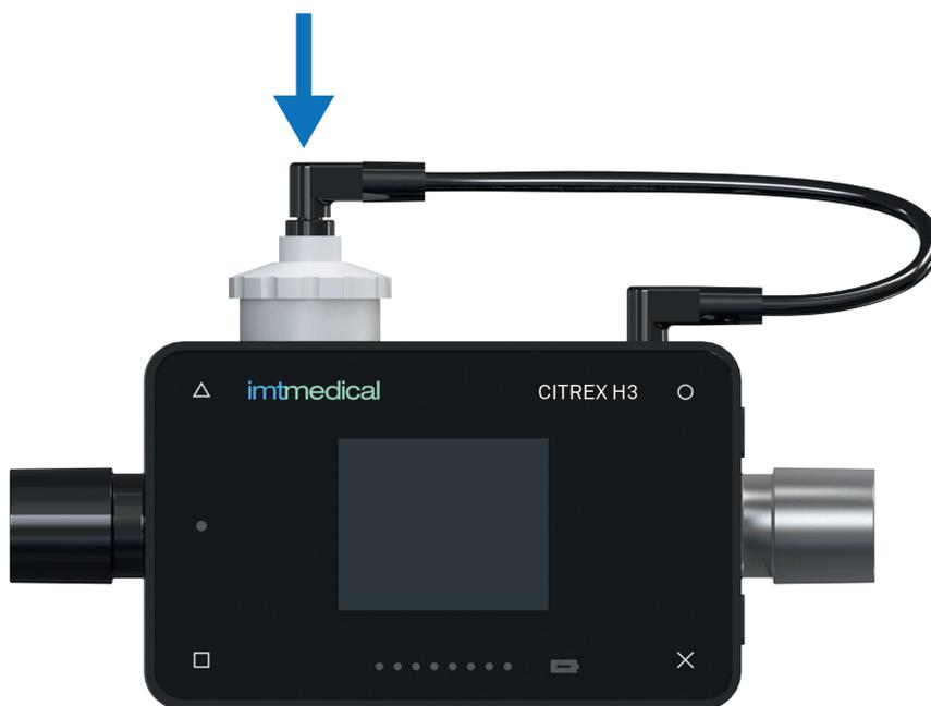
Abbildung 6: Sauerstoff-Sensor-Kabel
