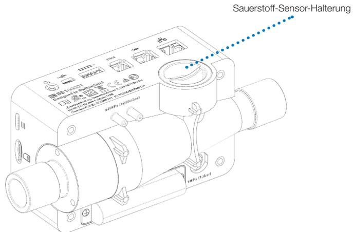
Abbildung 3: Sauerstoff-Sensor-Halterung
