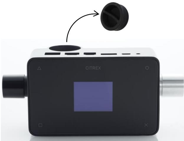
2. Setzen Sie den O<sub>2</sub>- Sensor durch drehen im Uhrzeigersinn ein und verbinden Sie Sensor und Gerät mit dem Sensorkabel.
