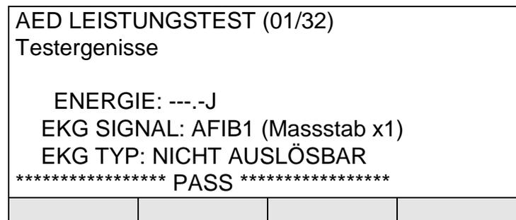
**Abbildung 76:** AED-Testergebnis: korrekt erkanntes, nicht auslösbares EKG-Signal.
