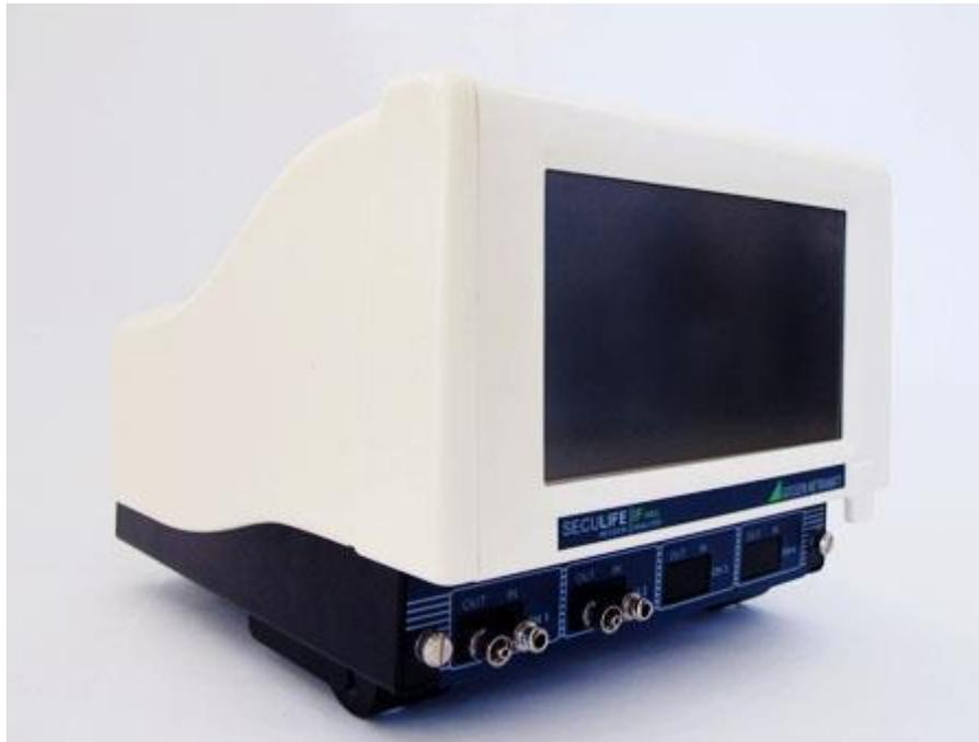
*Modular aufgebauter Infusionspumpentester für bis zu vier Testkanäle*
