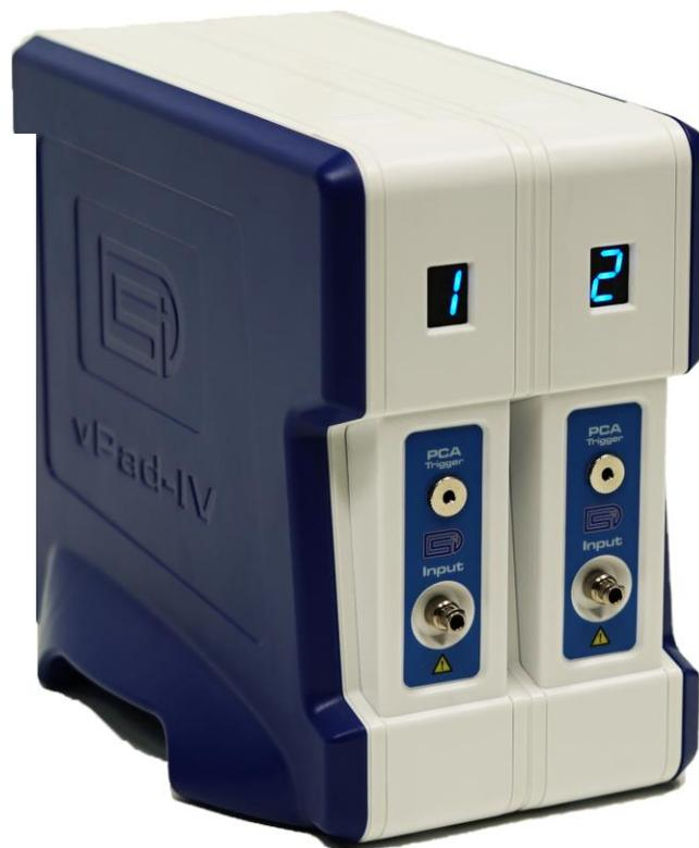
Modular aufgebauter Infusionspumpentester mit 1-6 frei kombinierbaren Kanälen. Das System besteht aus einer Steuereinheit (Tablet-PC + Controller inkl. 1 Messkanal) sowie bis zu 5 weiteren Messkanälen, die jederzeit entnommen oder hinzugefügt werden können.
